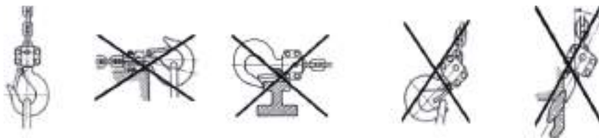
Рис. 6 Правильная фиксация тали и груза
