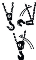
Рис. 5 Неправильное положение крюка
