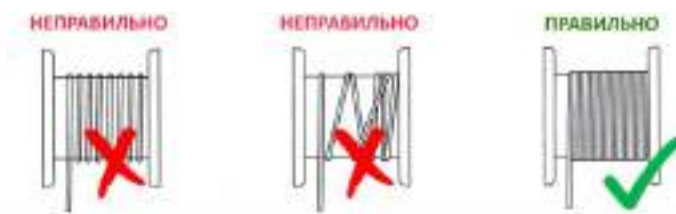
Рисунок 3. Намотка троса (ленты) на катушку.
