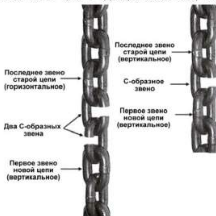
Рисунок 16 Соединение цепей.
