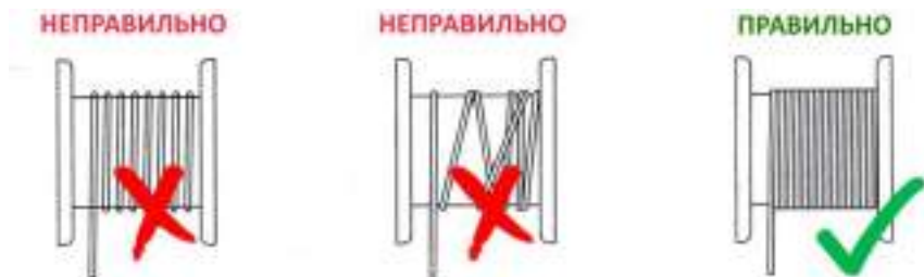
Рисунок 7. Правильность намотки грузоподъемного каната.
