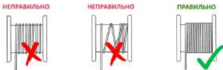
Рисунок 4. Намотка троса на барабан.
