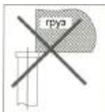
Рисунок 3. Расположение груза на рабочих площадках домкрата
